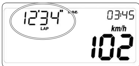
Fig5 Fonction temps au tour automatique
