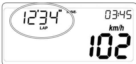
Fig5 Función cronómetro automático.
