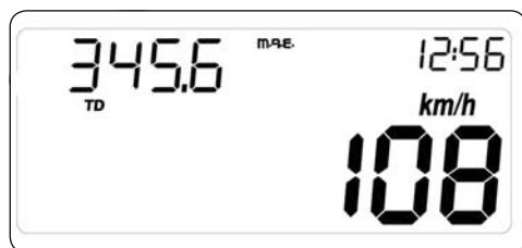
Fig3 Función contador automotático (cuenta hacia adelante).
