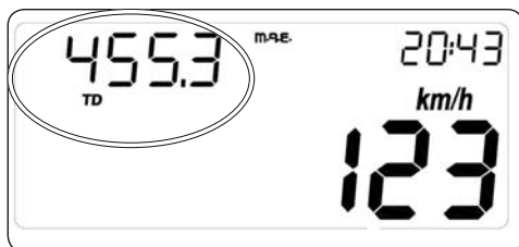
Fig9 Visualización de las horas de funcionamiento del vehículo.
