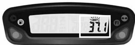
Fig 6 Función ajuste distancia
