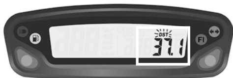
Fig 6 Fonction ajustement distance
