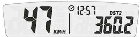
Display 2: Geschwindigkeit, Uhrzeit, DST2
